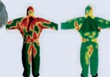
Il pannello traspirante posteriore dell'indumento 3M 4540 è progettato per favorire il ricircolo dell'aria e ridurre l'accumulo di calore all'interno del capo.
