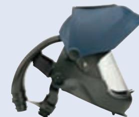
È la soluzione ottimale per i saldatori che necessitano sotto lo schermo di una visiera trasparente con ampio campo visivo. Basta abbassare il portafiltro da 90x110 mm per un facile passaggio alla saldatura. Peso dello schermo: 794 gr.
